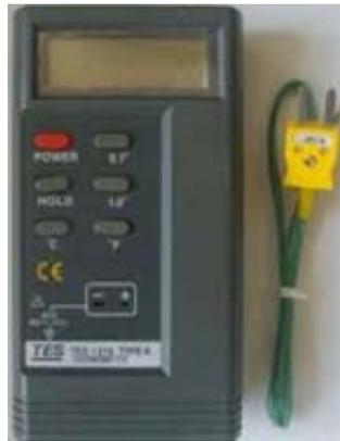
Fig. 3.2 Contact thermocouple
