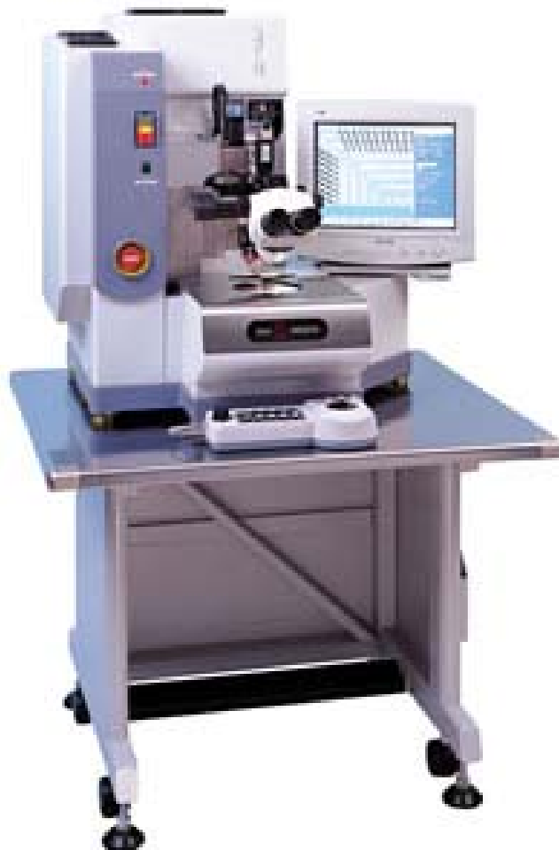
Fig. 2.28 An ASM AB520A automatic wedge bonder.
