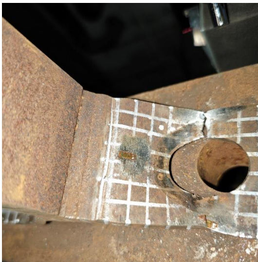
(a) Q690-H1-E80-Rig, 0.548 kJ/mm
