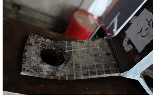
(b) Q460-H2-E40-Rig, 0.775 kJ/mm
