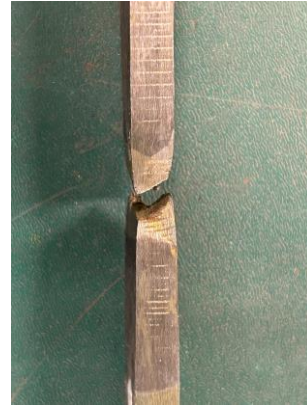
(d) Fracture at WM: Q460-B6-M-2
