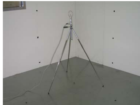
(d) Velocity measuring point at 1.1 m height
