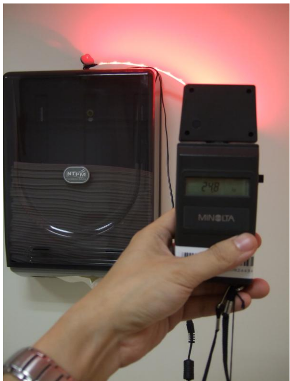
圖八) Minolta Illuminance meter TL1 於一米外測光：錄得 24.8 Lux
