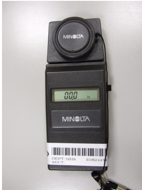
圖五) 測光用 Minolta Illuminance meter TL1 光照度錶 閉上測光儀時 0.00 Lux
