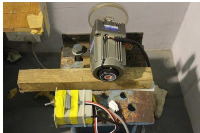
Figure 6.10. Electric motor
