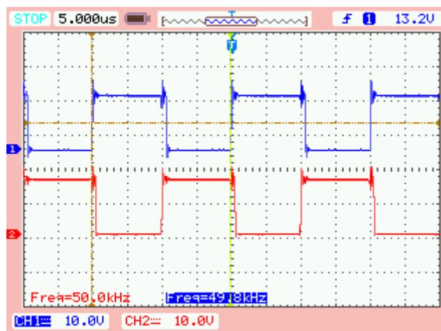
(a) Ch1:  $V_{GS1}$ ; Ch2:  $V_{GS2}$ ;
