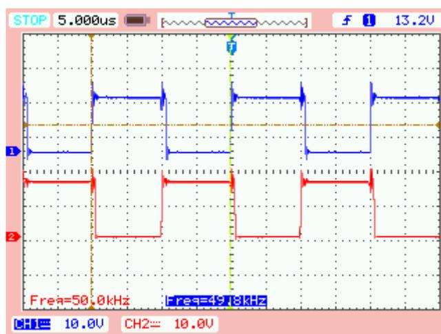
(a) Ch1:  $V_{GS1}$ ; Ch2:  $V_{GS2}$ ;
